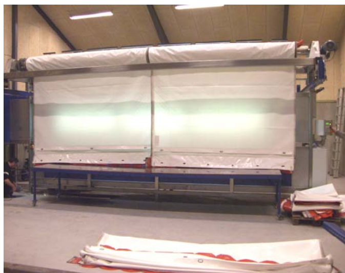
tagdugen køre ned foran lyset så evt. skader opdages
